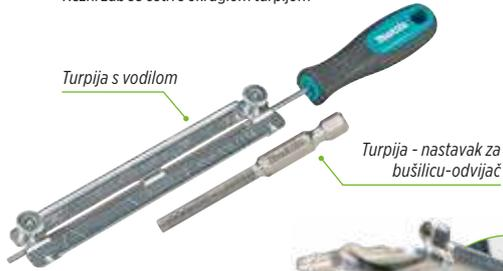
Tijekom brušenja okruglom turpijom pokušajte biti za 1/5 promjera turpije uvijek iznad vrha zuba. Za lakšu kontrolu preporučujemo korištenje vodilice
